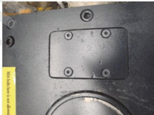
10. Используя герметик, загерметизируйте зазоры в верхней части подъемника.
